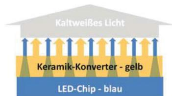
**Abb. 2:** Schema der Erzeugung kaltweißen Lichts auf Basis einer blau emittierenden LED und eines gelb emittierenden keramischen Konverters.
